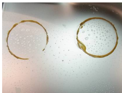
写真1 スチール缶を置いた箇所の例
